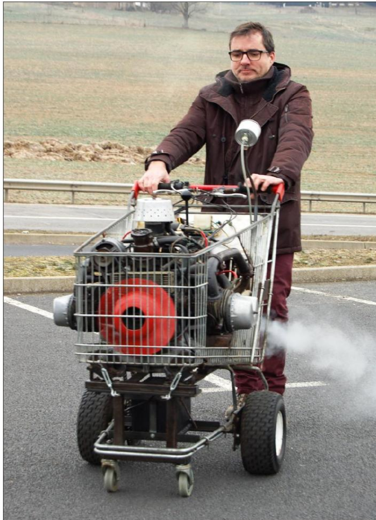
■ L'engin se déplace grâce à un moteur de 2CV6 (602 cm 3 ) placé dans le bac. Photo Olivier PIETROY
